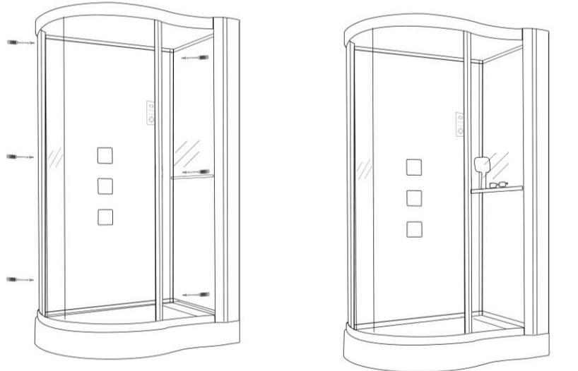
VI. Затем закрепите вертикальную планку саморезом M4\*10.
