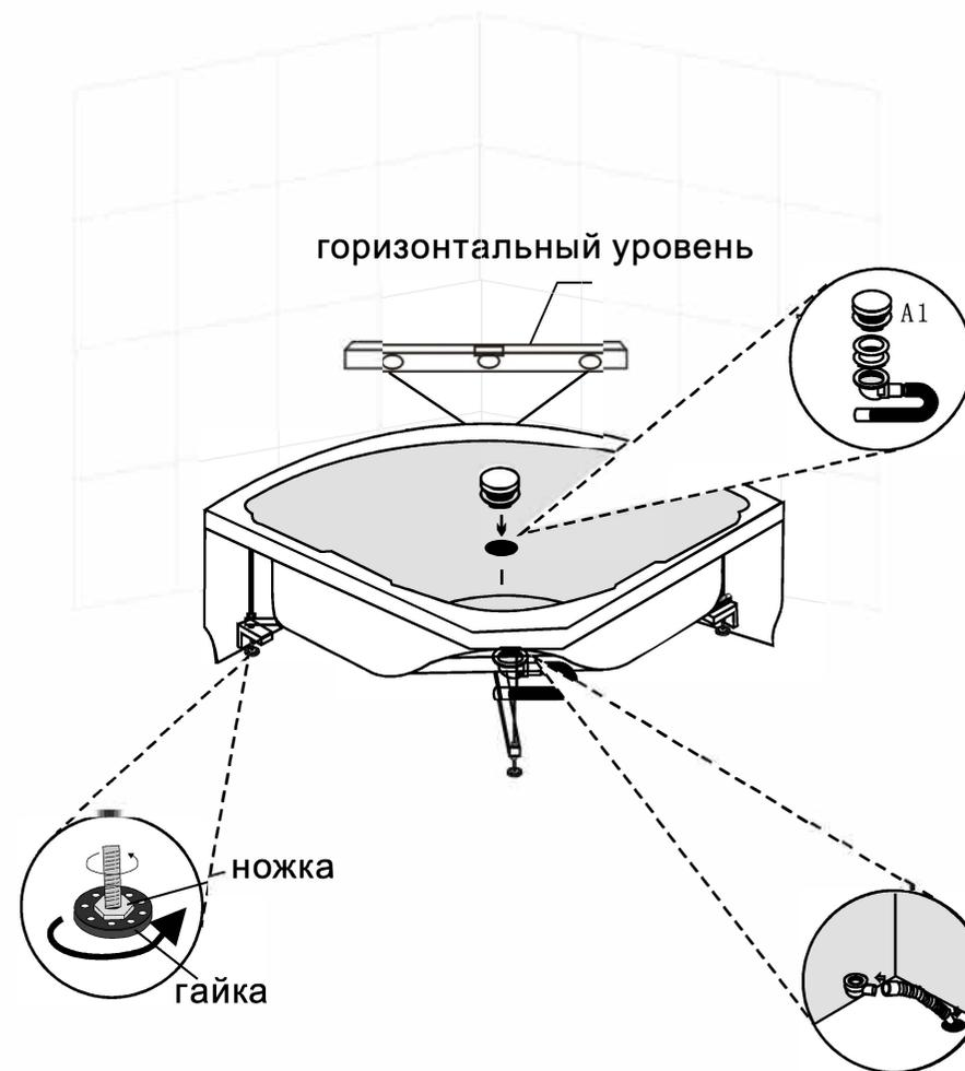
Проверьте поддон с помощью горизонтального уровня, отрегулируйте ножки, закрутите гайку
