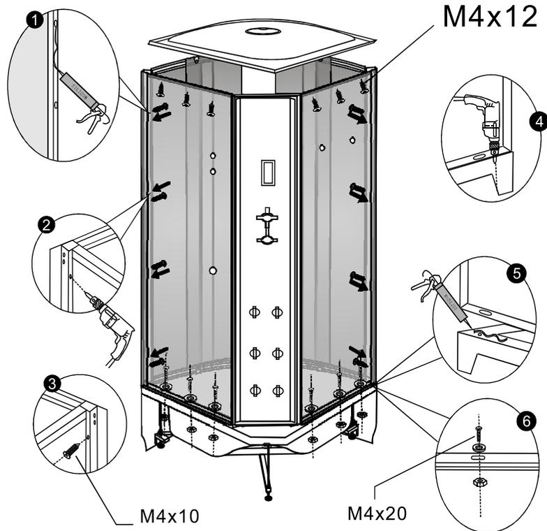
Вставьте заднюю стенку и дверцы в поддон, соедините их между собой с помощью креплений, затем отрегулируйте и закрепите заднюю стенку с поддоном, затем отрегулируйте положение кабины
