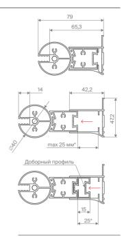
Регулировка осуществляется путем выдвижения профиля. Размеры указаны в мм.
