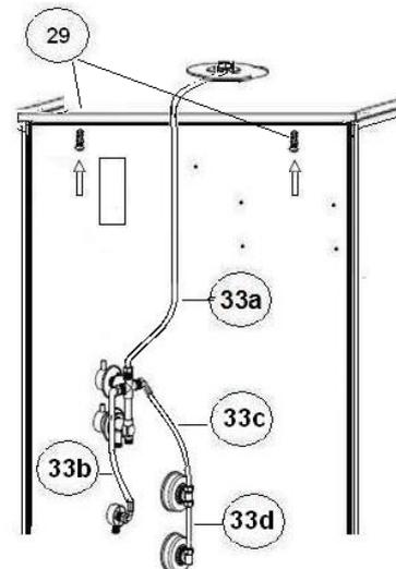
Подключите электрооборудование к электропитанию в соответствии с отметкой на проводах.
